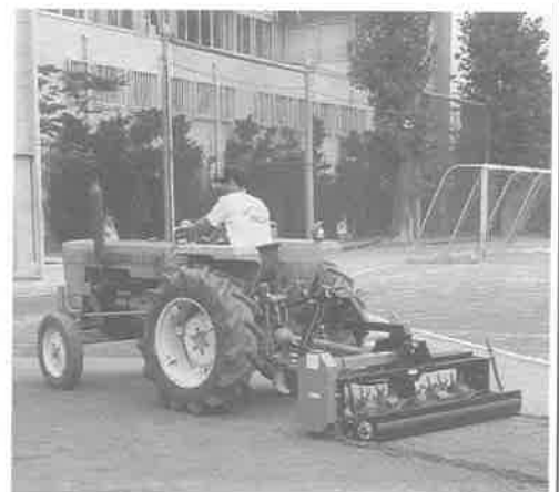
校庭整備で威力を発揮するバイブロ・レーキ
